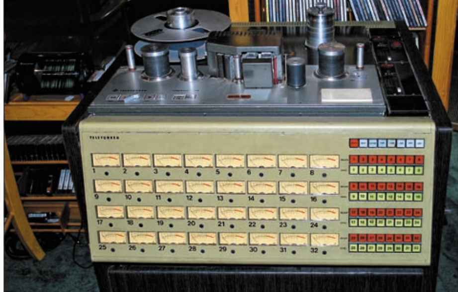
Ozdobą studia jest 24-śladowy Telefunken M15a, w którym nośnikiem jest 2-calowa taśma analogowa.
